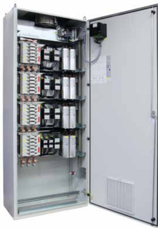
03 Blindleistungs-Kompensationsanlage LSFC 400 kvar, P7 verdrosselt
