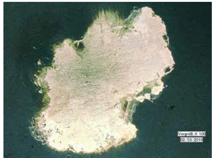
Selbstheilungsprozess in einer typischen metallisierten Folie
